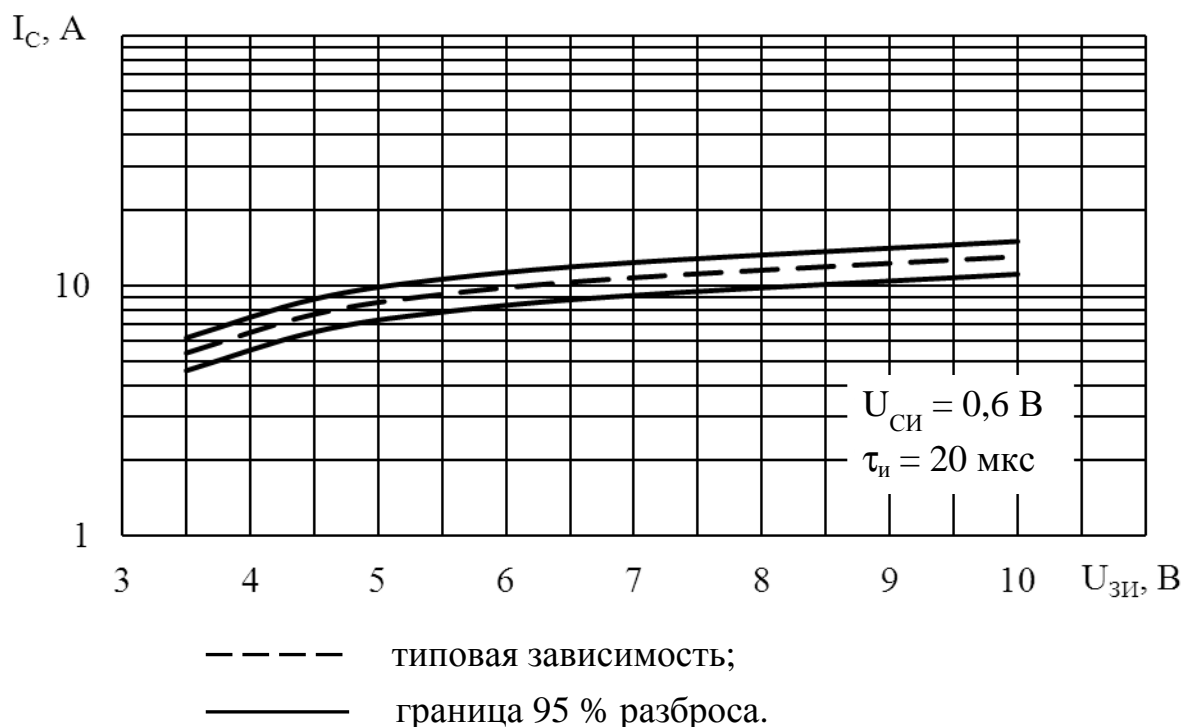
Рисунок И.67 – Область изменения тока стока в зависимости от напряжения затвор-исток транзистора сборки 2П7240ВС9 и транзистора с n -каналом комплементарной пары транзисторов 2П7247ВР9 при температуре окружающей среды t_c = (25 \pm 10)^\circ\text{C}
