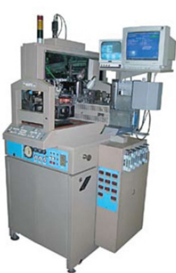
Автомат присоединения выводов ЭМ-4060
