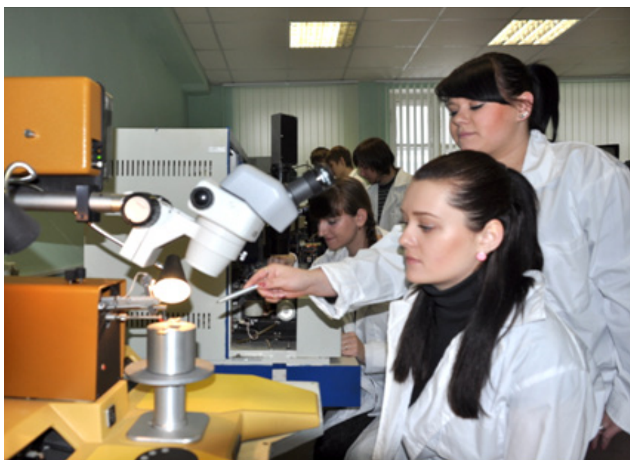
Автомат присоединения выводов ЭМ-4060
