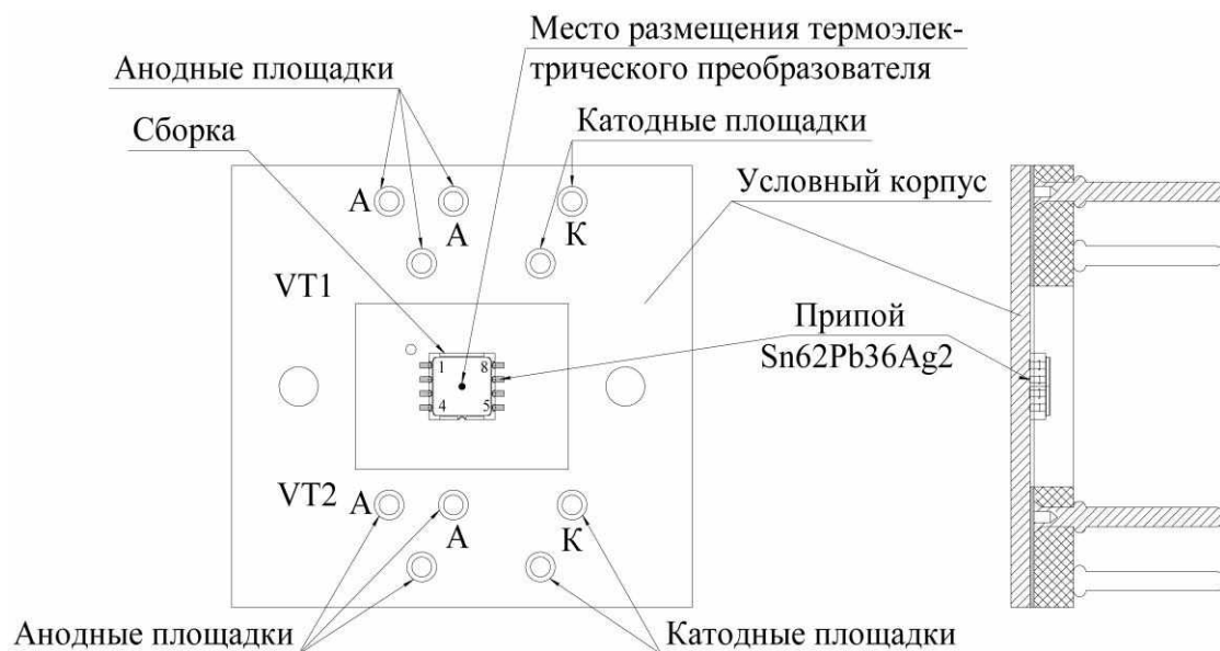
Рисунок 3 – Монтаж ограничителя напряжения КР1204А9 в условный корпус
